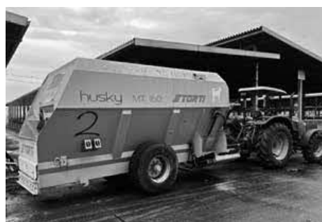
カッティングミキサー（混合飼料を調製するための機械）
