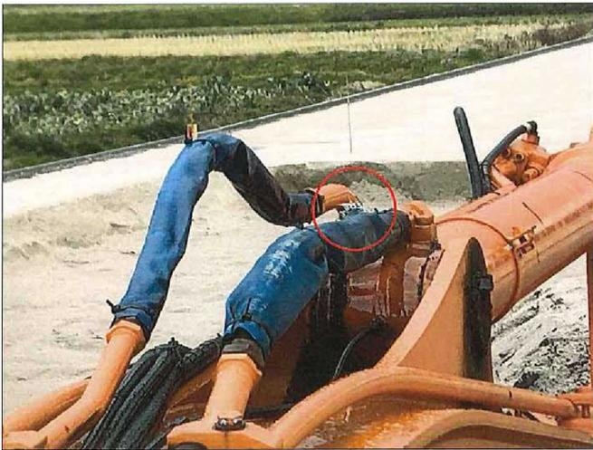
バックホウ油圧ホース破裂状況
