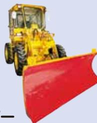
前面にある「プラウ」という鉄の板を操作し、雪をかき分けます。
