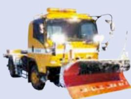
前面にあるプラウで雪を道路わきに飛ばして寄せます。除雪車の中で一番スピードがです。
