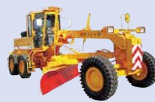
車体の下に付いている「ブレード」という装置で、路面の凍った固い雪を削れます。
