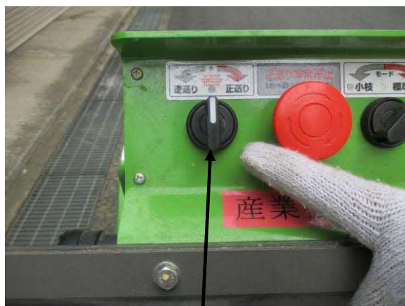
送りスイッチが「停止」状態の時は、ローラーが回転しません。
