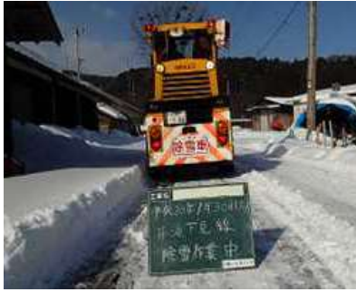
現在使用中のロータリー
