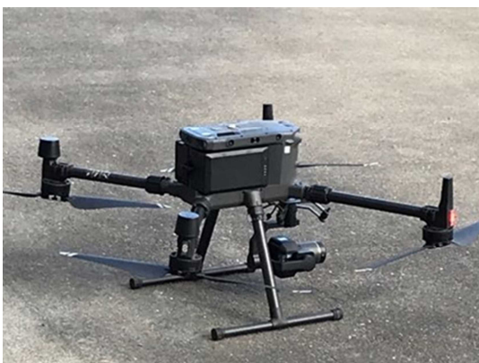
「無人航空機(マルチコプター)を利用した橋梁点検画像取得装置 M300RTK-i」 【BR010028-V0223】
