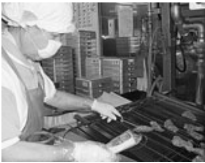
はまちの竜田揚げを作っているところ。中心温度が75℃で1分以上加熱しているかどうかを確認するため、温度を測定する
